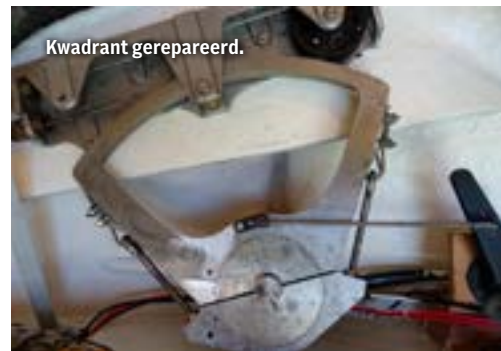
Kwadrant noodreparatie, gefixeerd met griptang en slangkleem.
